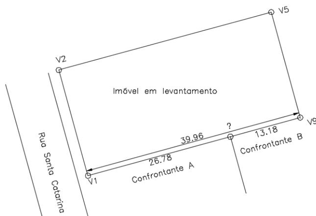
Figura 4: Exemplo da aplicação do método do alinhamento
